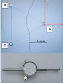
Qualora si richieda un'accuratezza di misura superiore a quella millimetrica è necessario ricorrere a dispositivi (deformometri removibili o crepemetri) che permettono di monitorare mediante misure con un comparatore analogico o digitale l'evolversi della distanza tra due o più riferimenti vincolati alla struttura (caposaldi a barra o a dischetto).
