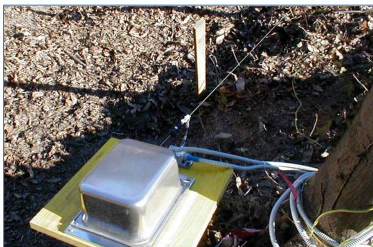
**Esempio di installazione dell'estensimetro a filo**
