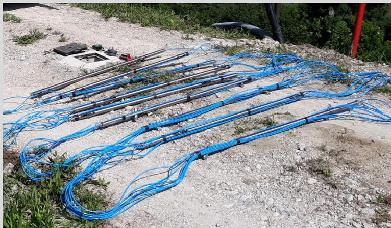
Tutte le parti meccaniche sono realizzate in acciaio inox. Il vano che contiene i sensori e l'elettronica di condizionamento è resinato, per garantire la massima tenuta nel tempo contro le infiltrazioni d'acqua.
