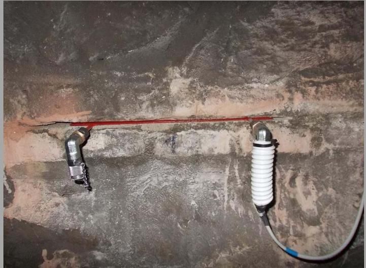
Il martinetto strumentato è costituito da un piatto idraulico di forma semicircolare formato da due piastre metalliche saldate lungo l'intero perimetro che formano un'intercapedine satura con olio disareato.
