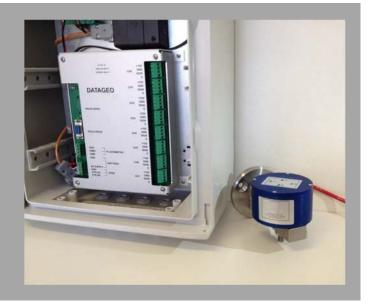
Il modulo MDS è costituito da un accelerometro triassiale e da un inclinometro biassiale con termistore incorporato. I sensori sono di tipo micro elettromeccanico MEMS. La regolazione di durata di registrazione (5/10/20 sec) consente il monitoraggio di vari tipi di eventi accelerometrici.
