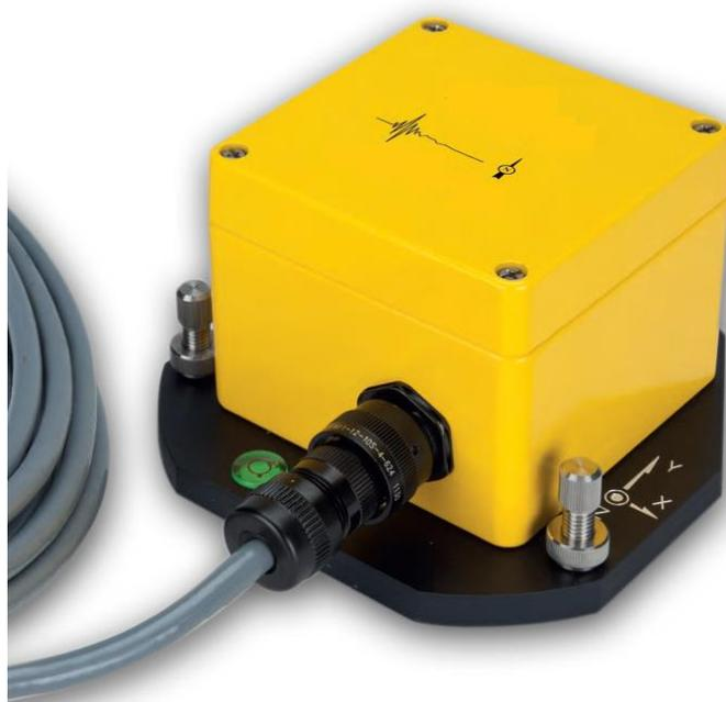
Sismometro tridirezionale conforme alle normative DIN4150-3, DIN45669-1, UNI9916 e UNI 9614.
