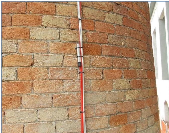
I sensori termici comprendono un corpo cilindrico in acciaio e un termistore in platino al suo interno. La resistenza elettrica del diaframma di metallo varia linearmente con la temperatura. Le resistenze al platino assicurano stabilità, ripetibilità e precisione elevate delle misure.
